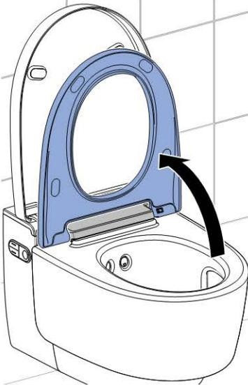
**2** Schieben Sie den Entriegelungsknopf nach rechts, und heben Sie den WC-Sitz aus der rechten Halterung.
