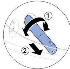
**5** Ziehen Sie die Dushdüse zur Reinigung und Entkalkung ab.
