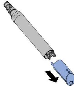
**6** Ersetzen Sie die Dushdüse, falls sie sich nicht mehr vollständig reinigen und entkalken lässt.
