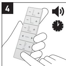
> Appuyer sur Arrêt pour terminer le nettoyage. Il s'arrête automatiquement au bout de 2 min.
